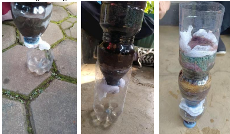
Gambar 2. Dari kiri ke kanan: hasil filtrasi sampel A (set alat: zeolit ukuran kecil, arang kayu, kerikil dan pasir), sampel B (set alat: zeolit ukuran medium, arang kayu, kerikil dan pasir) dan sampel C (set alat: zeolit ukuran besar, arang kayu, kerikil dan pasir)
