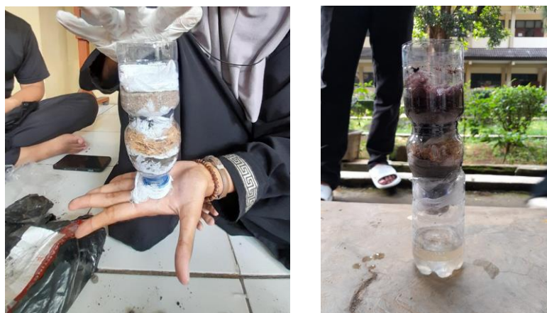
Gambar 4. Set alat filtrasi optimum terdiri dari zeolit ukuran kecil (1-2 mm), arang batok kelapa, kerikil dan pasir (kiri). Hasil filtrasi limbah batik dengan set alat filtrasi optimum (kanan).
