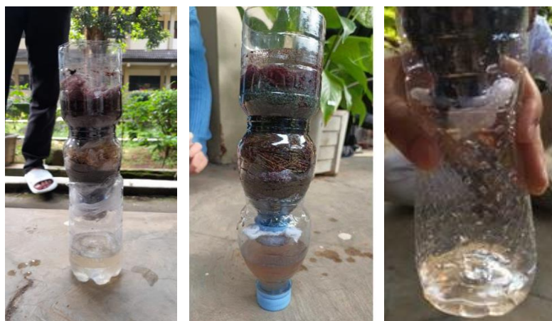
Gambar 3. Dari kiri ke kanan: hasil filtrasi sampel D (set alat: zeolit ukuran kecil, arang batok kelapa, kerikil dan pasir), sampel E (set alat: zeolit ukuran medium, arang batok kelapa, kerikil dan pasir) dan sampel F (set alat: zeolit ukuran besar, arang batok kelapa, kerikil dan pasir)
